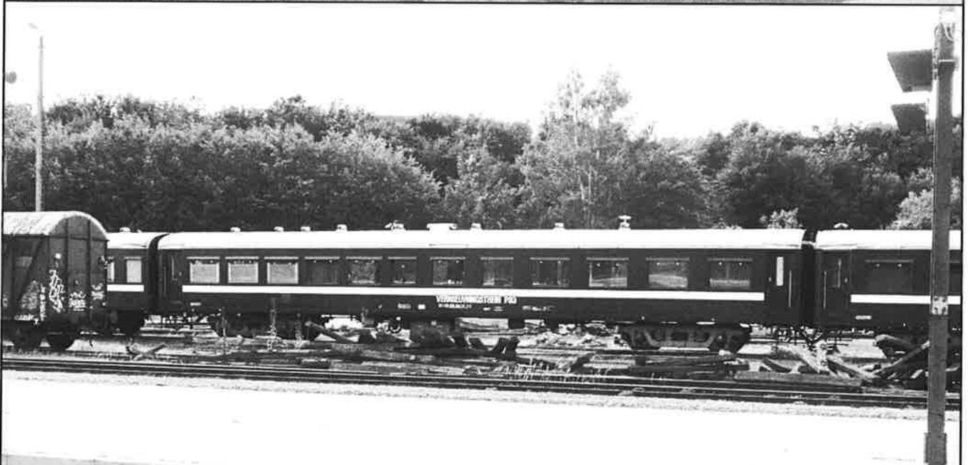
15 septembre 2010 : un train de travaux stationne en gare de Walcourt. Il est formé de voitures intermédiaires provenant des automotrices quadruples de 1935 pour la liaison Bruxelles-Nord - Antwerpen-Centraal. Véhicules transformés en voitures pour le logement du personnel de travaux.
